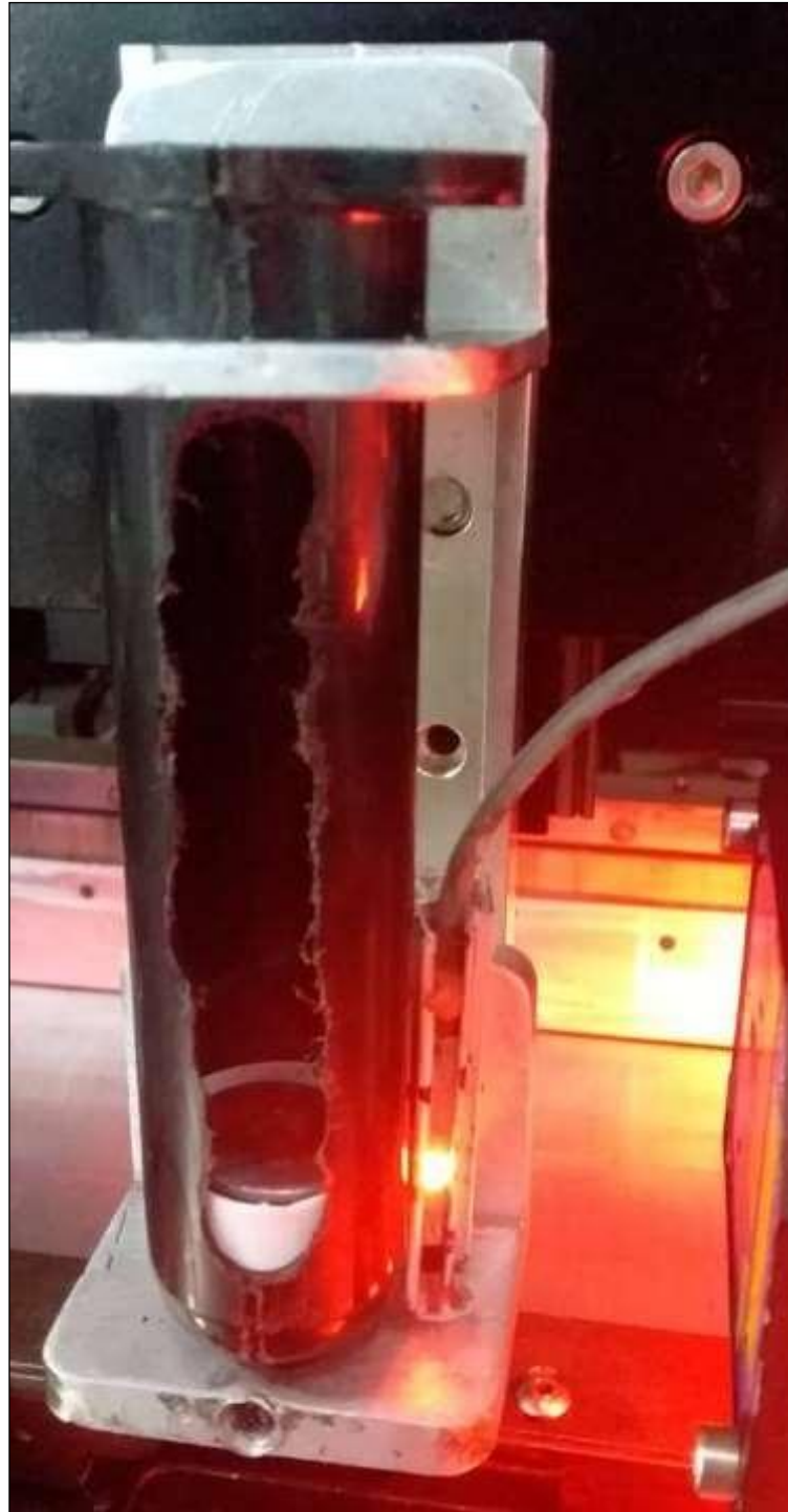
Bismaga inserida na máquina Camalot com o imã inserido no êmbolo.
