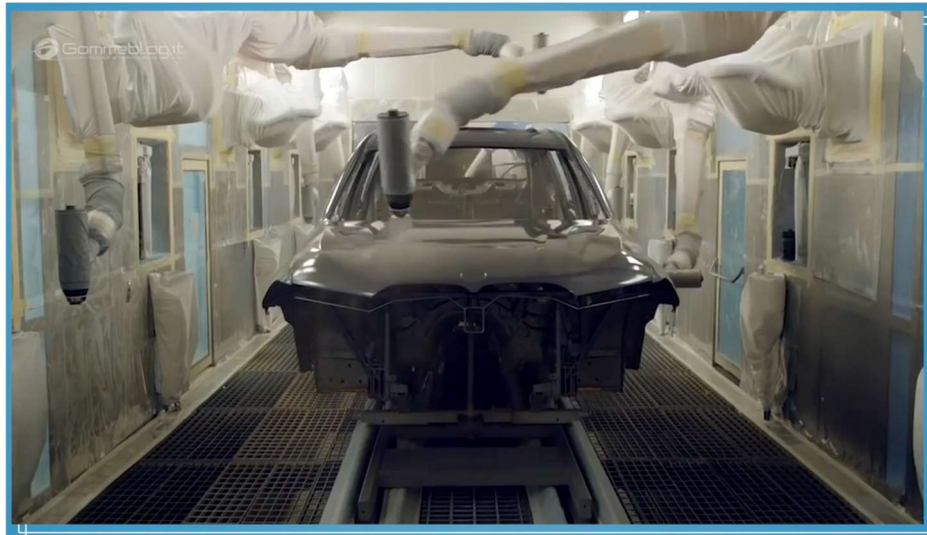
Figura 5- Processo de pintura com pulverização pneumática
