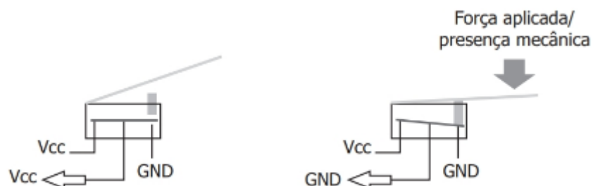
Figura 2 – Sensor fim de curso e seu funcionamento.
