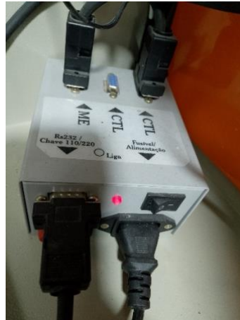
Figura 39 – Interface de comunicação entre o computador e o controlador.
