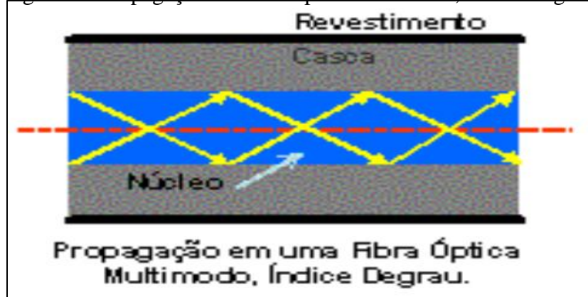
Figura 6 - Propagação em fibra óptica multimodo, índice Degrau
