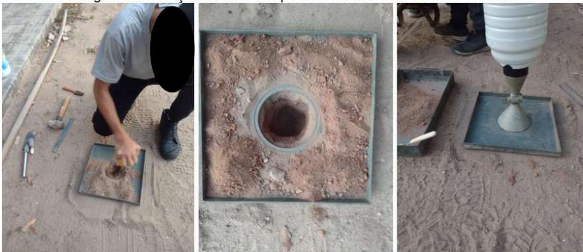
Imagem 3: Execução da massa específica “in situ” com o frasco de areia.
