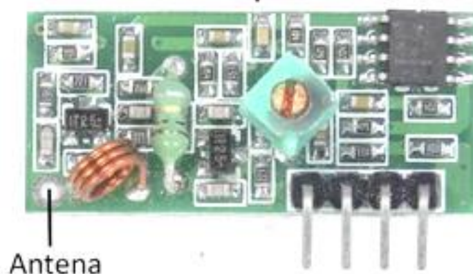
Figura 3. Módulo RF 433MHz – Receptor. Fonte: ELETROGATE.
