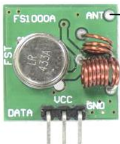
Figura 2. Módulo RF 433MHz – Transmissor. Fonte: ELETROGATE.
