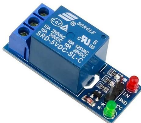
Figura 8. Módulo Relé 1 canal. Fonte: ELETROGATE.
