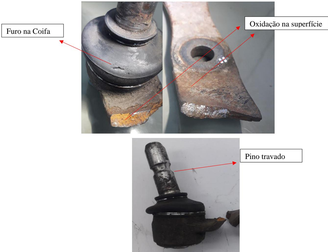
Afim de evidenciar se o pino, ou a carcaça do conjunto apresentava sinais de batidas oriundas de acidentes ou sobrecargas, ou mesmo vestígios de pino rompido e coifa rasgado, foi observado que não houve vestígio de impacto sobre a peça, conforme a figura 22. Porém, foi verificado que a porção de borracha continha um furo, figura 15, e a peça possuía oxidação em sua superfície.
