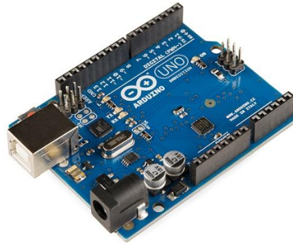
Figura 12 – Modelo Placa Arduino UNO. CC BY 2.0. Fonte: Wikimediacommons.com
