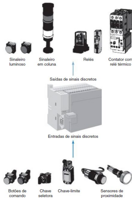
Figura 10- Dispositivos de entrada e saída de E/S de sinais discretos.
