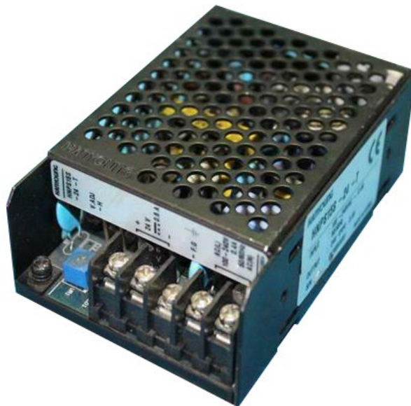
Figura 25- Fonte da fabricante Hanyoung- HNPS50S-24-T.
