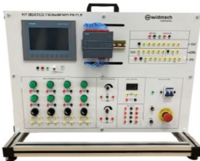
Figura 28- Kit Didático Treinamento em CLP – Widetech.
