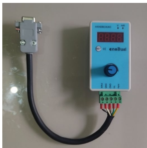
Figura 40- Ligação do chicote ao gerador de sinal.
