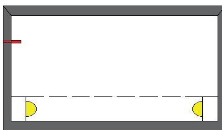
Figura 26 - Estrutura interna da caixa e posicionamento dos sensores
