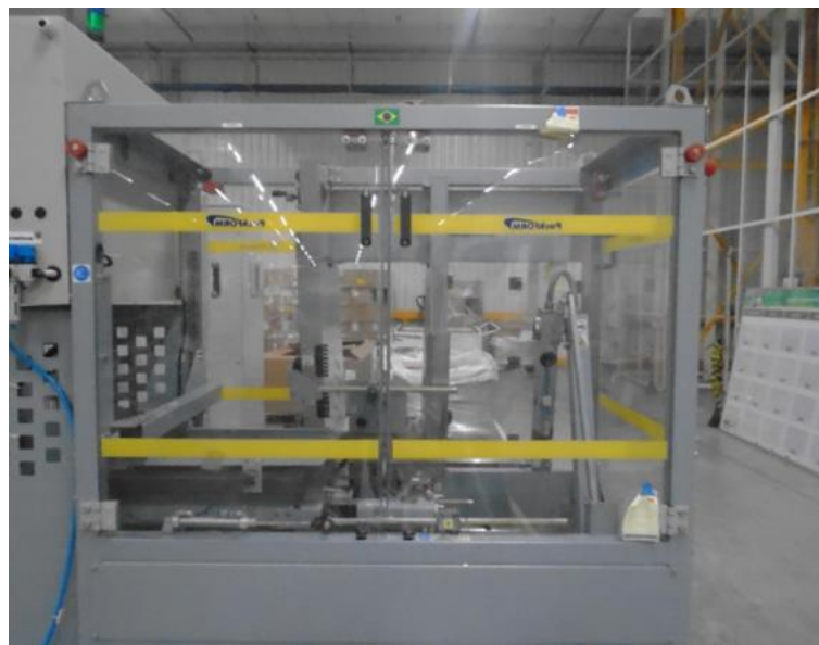
Figura 9 - Montadora automática de caixas
