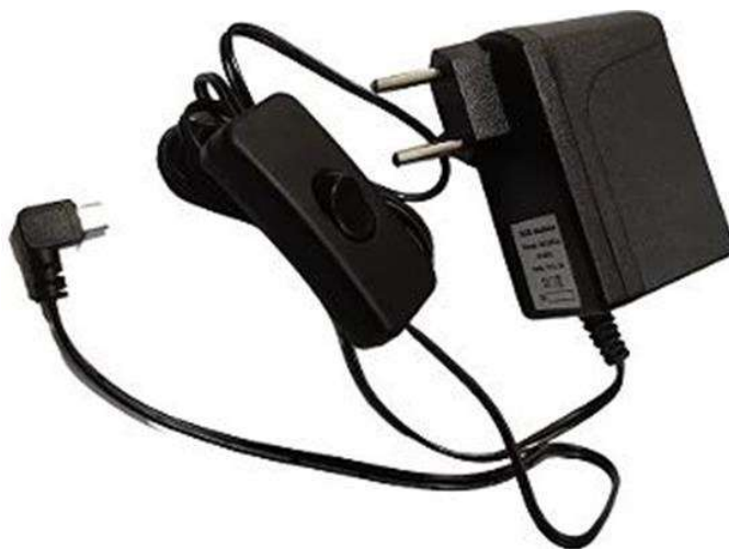
Figura 30 – Fonte projetada para a placa comercial Raspberry Pi 3B+ , com botão liga/desliga.
