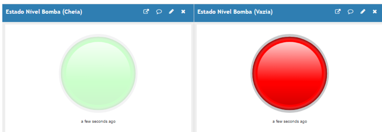
Figura 55 - Estado da caixa d' água, reservatório vazio (luz vermelha acesa) e reservatório cheio (luz verde acesa).
