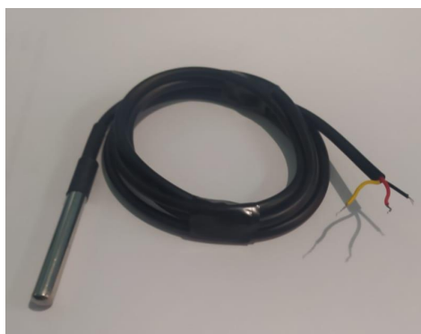
Figura 4 - Sensor de temperatura encapsulado a prova d' água DS18B20.
