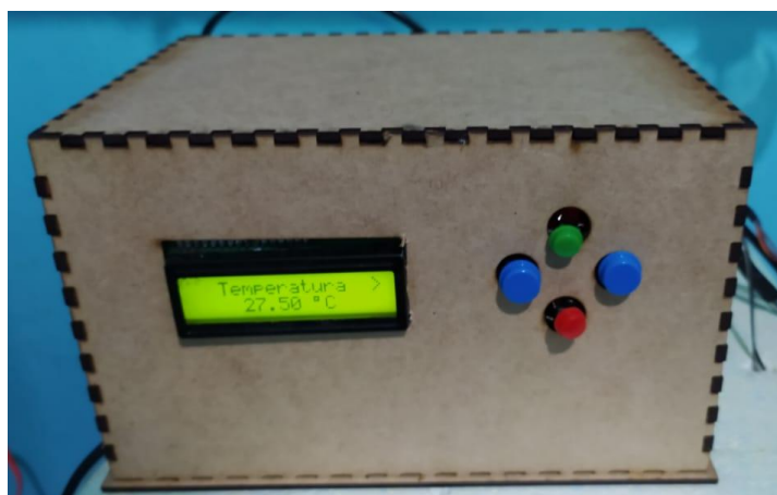
Figura 43 - Case de MDF com o sistema de controle e acionamento em sua parte interna.
