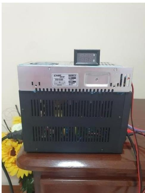
*Figura 16: Fonte comeia 12v, fonte bancada 12v e medidor de temperatura - (autoria própria)*
