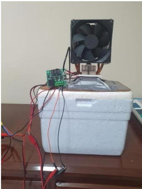
*Figura 14: Caixa de isopor de 3 litros, cooler dissipador e termostato.*
