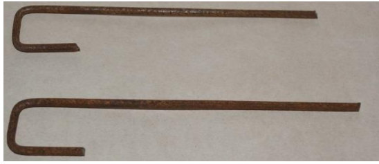
Figura 56 – Estacas de ferro para segurar a base do foguete Fonte: MOGFOG,2018.
