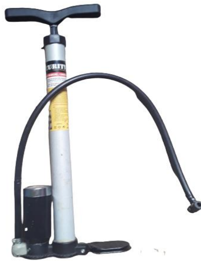
Figura 57 – Bomba de Encher pneus de Bicicleta para ser usada no Válvula da Base Fonte: Elaborada pelo autor (2022).
