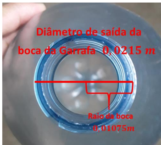
Figura 59 – Diâmetro de saída da boca da Garrafa Fonte: Elaborada pelo autor (2022).
