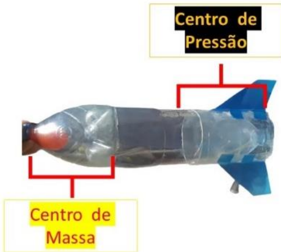
Figura 31 – Centro de Massa e Centro de Pressão do Foguete de Garrafa Pet Fonte: Elaborada pelo autor (2022).
