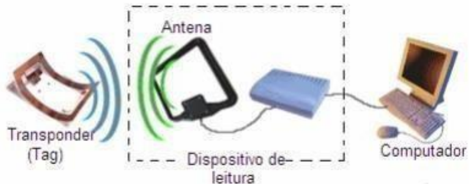
Figura 1 – Composição básica de um sistema RFID
