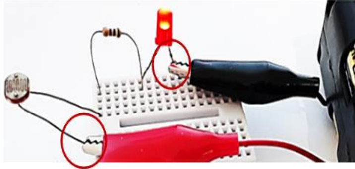
Fotografia 18: Terminais da bateria no LED e no LDR.
