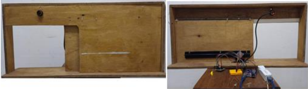
Fotografia 3: porta montada com o sensor infravermelho embutido no Arduino e seus componentes eletrônicos.
