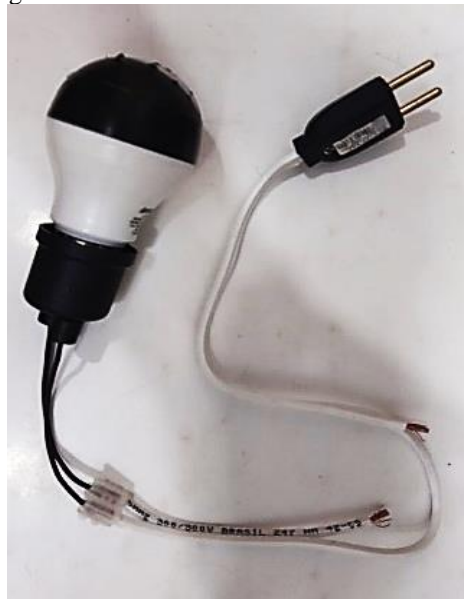
Fotografia 31: Conexão do bocal no fio e na tomada.
