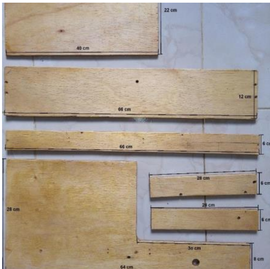
Fotografia 1: Peças de madeira com as medidas para a construção da porta.:
