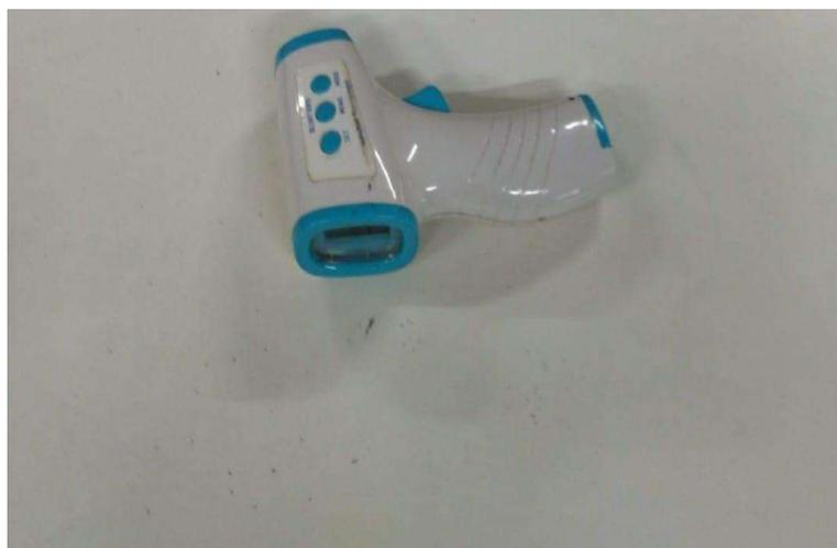
**Figura 6: Material - Termômetro Digital.**
