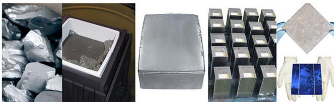
Figura 13 - O minério de silício purificado, a fundição em bloco do silício, os “tijolos de silício” cortados, as fatias (wafers) e a célula fotovoltaica policristalina.
