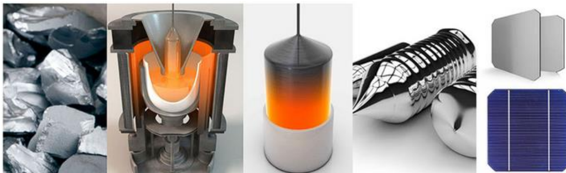
Figura 12 - O minério de silício purificado, o forno de Czochralski, lingote de silício, as fatias (wafers) e a célula fotovoltaica monocristalina.
