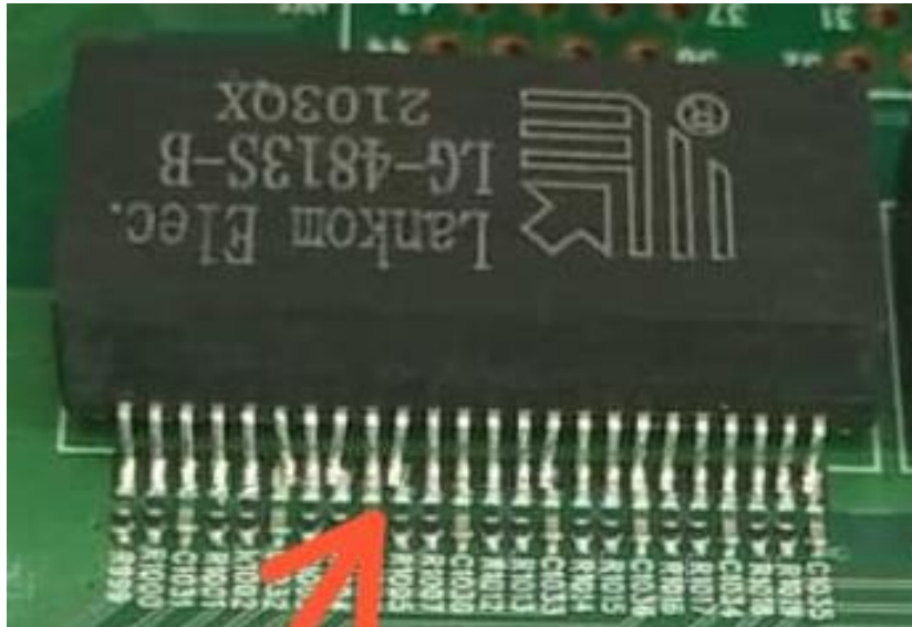
Figura 11: Insuficiência de Solda
