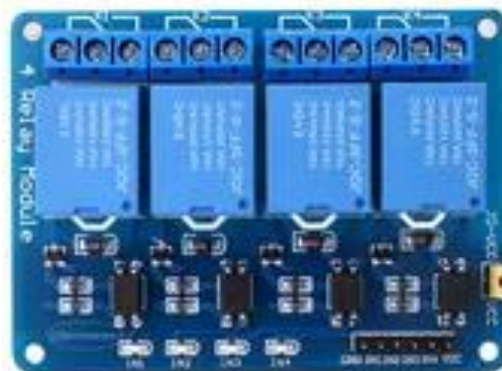
Figura 11 - Módulo Relé Fonte: Autor
