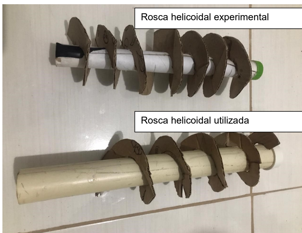
Figura 21: Rosca helicoidal com diferentes eixos.
