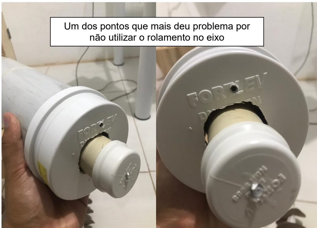
Figura 22: Suporte do eixo que estava travando.
