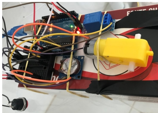
Figura 2. Teste de programação inicial do Arduíno com os outros componentes.
