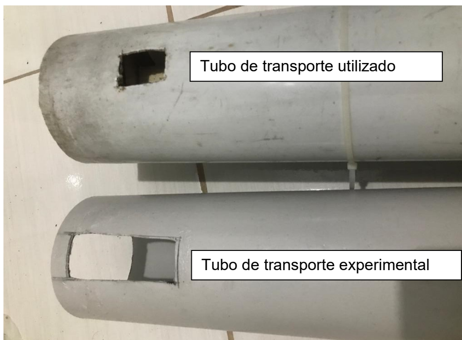
Figura 20: Redução da entrada do tubo de transporte.
