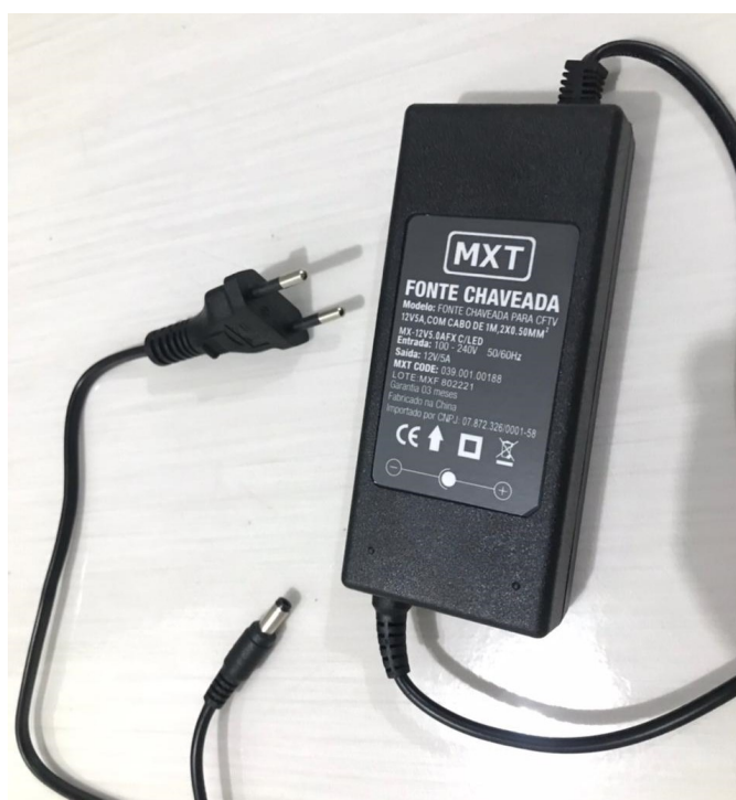
Figura 8. Fonte Chaveada 12V 5A 60W. Usada para alimentar o Arduíno.
