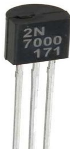
Figura 16 - Transistor MOSFET com encapsulamento TO-92
