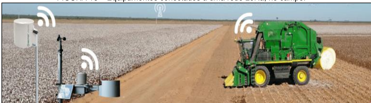
FIGURA 16 – Equipamentos conectados à uma rede LoRa, no campo.
