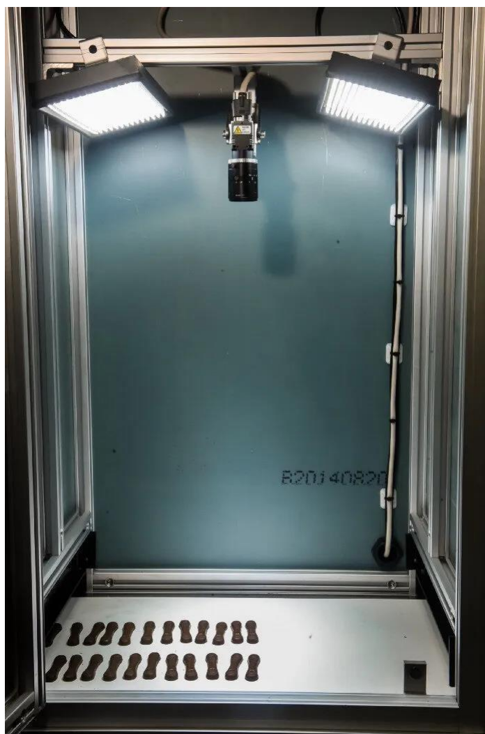
Figura 9 - Sistema de inspeção de qualidade com visão computacional
