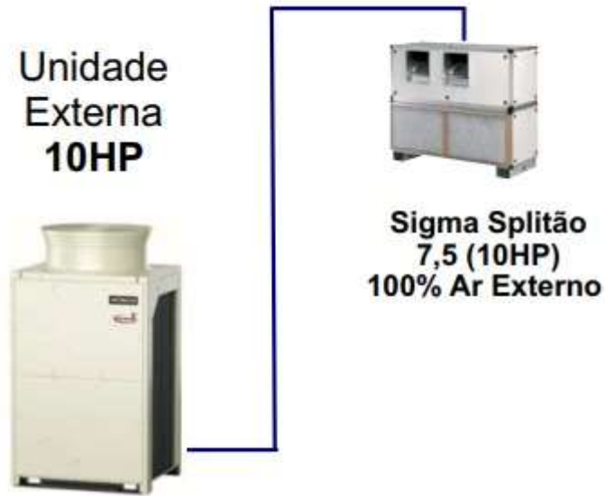
Figura 24 – Unidade de Tratamento de ar Externo
