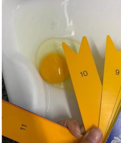
**Figura 4:** Verificação da cor da amostra de acordo com leque colorimétrico DSM®.
