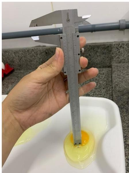
**Figura 5:** Utilização do paquímetro para medição da altura da clara.
