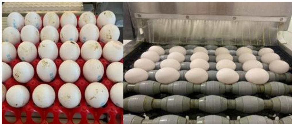
**Figura 2:** Ovos sujos selecionados para lavagem em máquina lavadora YAMASA®.
