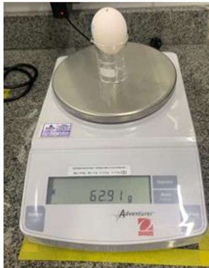
**Figura 3:** Pesagem das amostras em balança semi-analítica.
