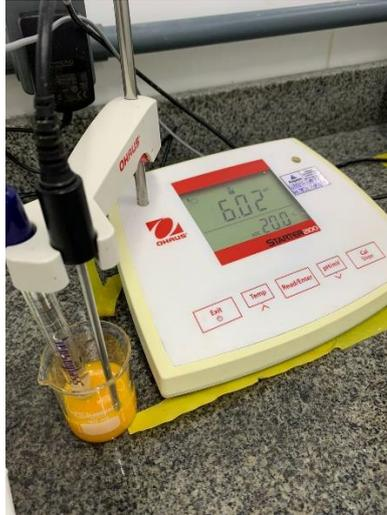
**Figura 6:** Medição do pH da amostra.
