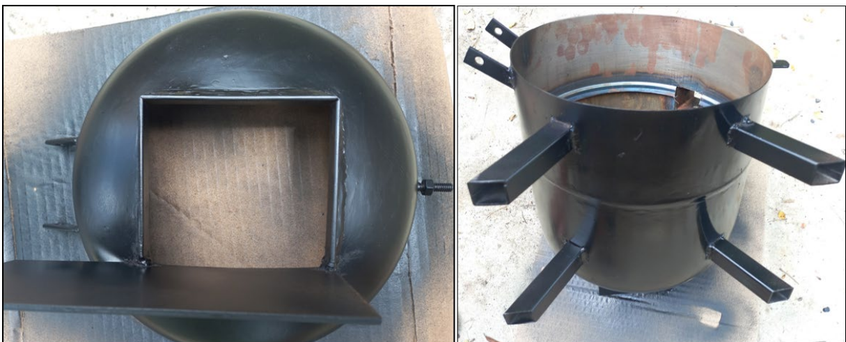
Figura 22: Pintura da estrutura da forja.
