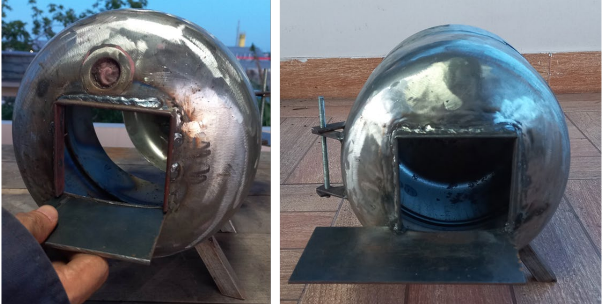
Figura 19: Chapas de suporte soldadas nas aberturas de exaustão posterior e frontal.
