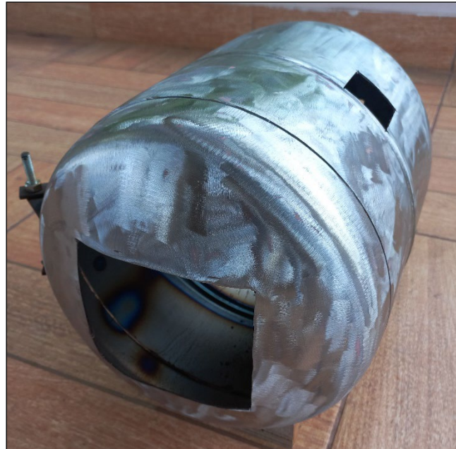
Figura 13: Abertura lateral para o suporte do queimador.
