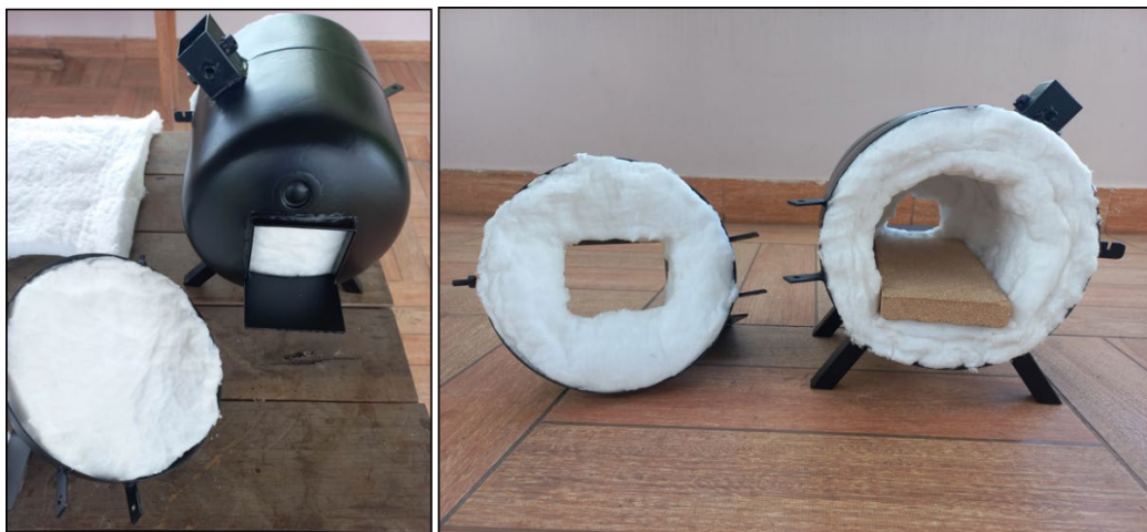
Figura 24: Forja com revestimento completo.
