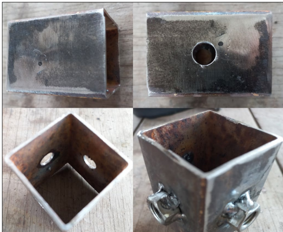
Figura 20: Peça de metalon para suporte do queimador.
