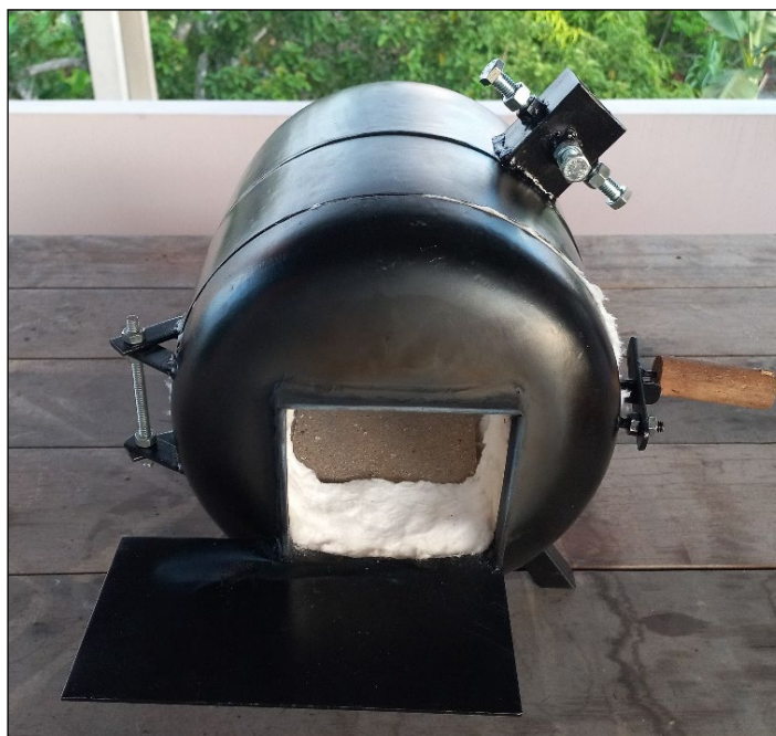
Figura 25: Estrutura da forja finalizada.
