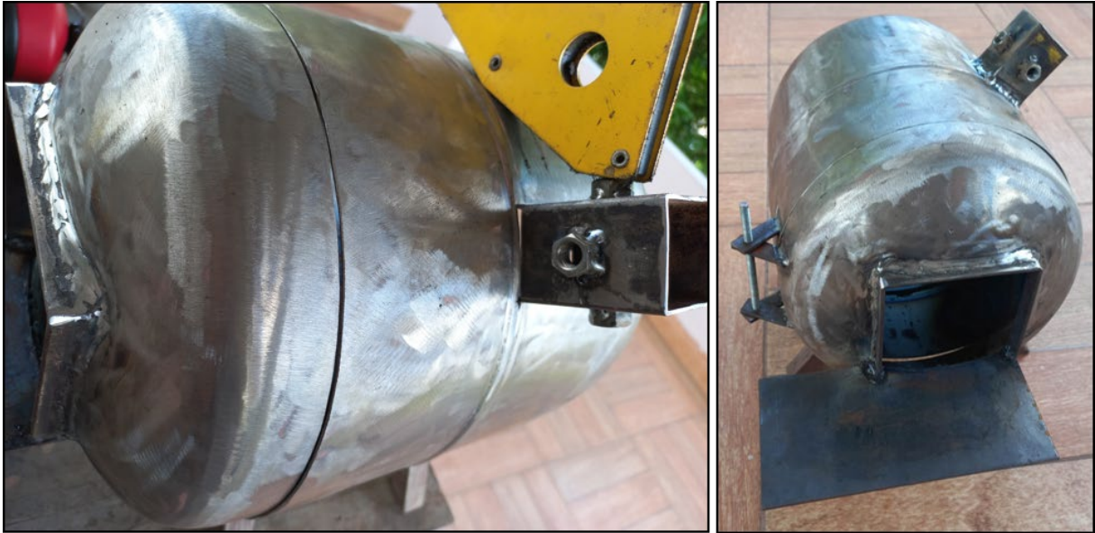
Figura 21: Posicionamento e soldagem do suporte do queimador.
