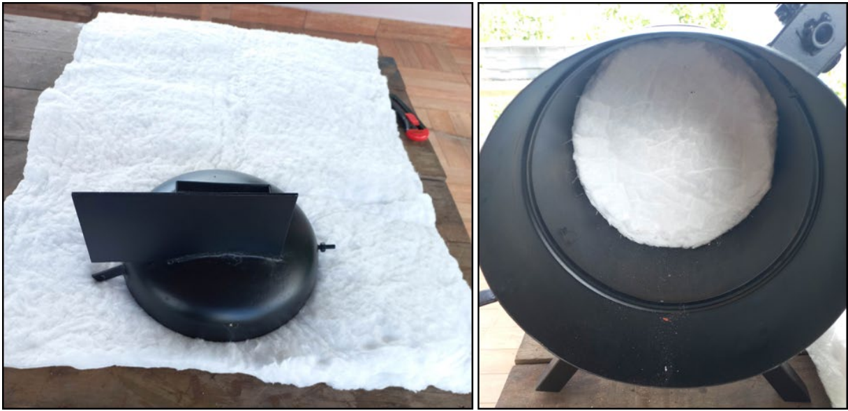
Figura 23: Marcação e recorte da fibra cerâmica.
