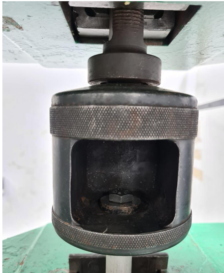
Figura 9 – Dispositivo acoplado ao parafuso na máquina de tração.
