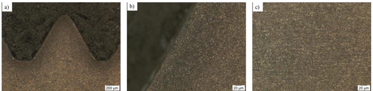
Figura 19 – Microestrutura parafuso normatizado a) x100, b) 500x flanco e c) x500 núcleo.
