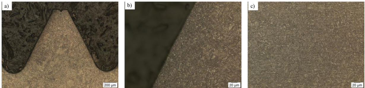
Figura 18 – Microestrutura parafuso genérico a) x100, b) 500x flanco e c) x500 núcleo.
