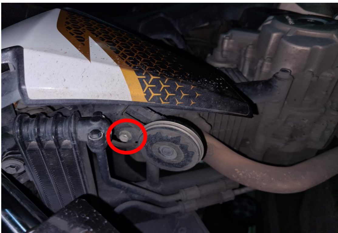
Figura 1 – Exemplo de união entre o chassi e o suporte da buzina
