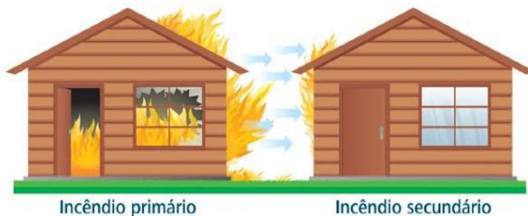
Figura 3 - Transferência de calor por ondas de irradiação
