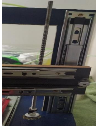
Figura 29 Eixo Z Finalizado
