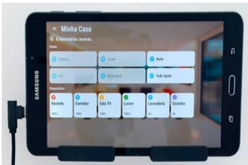
Figura 25 – Central de comando e controle dos aparelhos de automação.
